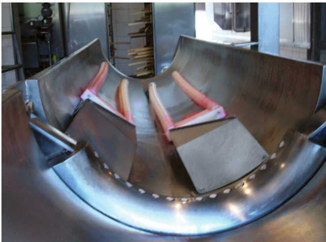
Bügel mit Messköpfen im Messkanal Étrier avec transducteurs dans le canal de mesure
